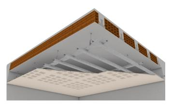
Meccanica - **FIBRAN***profiles* guide e montanti, passo 9000 mm per la struttura portante, passo 333 mm per la struttura secondario, spessore 6/10 di mm conformi alla norma UNI EN 14195.
