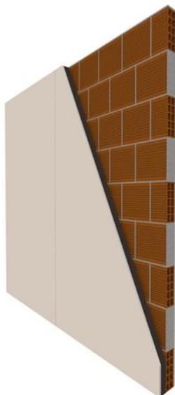
**Termica** -  $U = 0,320$  W/m<sup>2</sup>K esempio su mattone forato intonacato su ambo i lati e pannello **FIBRANgyps AEps G 13+80** - calcoli eseguiti con software PAN.
