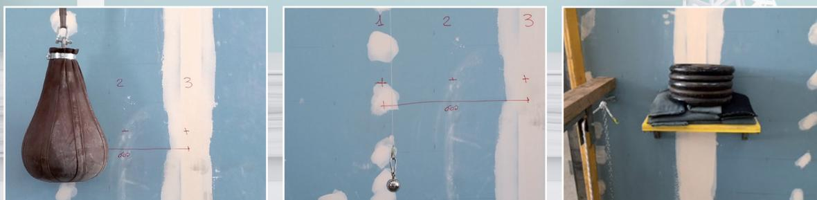
I test eseguiti sono la resistenza al corpo molle ovvero un sacco da 50 kg rilasciato in caduta libera sulla parete in diversi punti e con varie potenze, la resistenza al corpo duro ovvero una sfera in acciaio da 1 kg, anch'essa lasciata cadere contro la parete con la stessa modalità e la resistenza al carico eccentrico (mensola).
