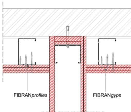
Part. 1 Raccordement à cloison coupe-feu
