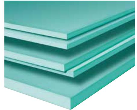
Si tratta di un prodotto speciale in polistirene estruso, senza pelle, certificato per l'uso all'interno dei sistemi a cappotto. La goffatura superficiale (in rilievo) assicura un'eccellente adesione del rasante mentre la struttura interna lo rende moderatamente traspirante (MU = 50). Di natura termoplastica, ha una buona stabilità dimensionale al variare di temperatura e umidità. Grazie al comportamento viscoelastico, assorbe le tensioni interne provenienti dagli altri componenti del cappotto.
