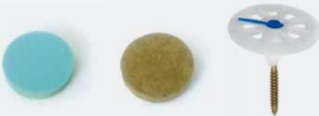
Dischi isolanti rigidi in lana di roccia o polistirene estruso per la riduzione delle dispersioni termiche generate dai gambi metallici dei tasselli di fissaggio
