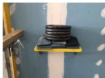
I test eseguiti sulla parete FIBRANGyps **SUPER 125/75 mw** sono la resistenza al corpo molle ovvero un sacco da 50 kg rilasciato in caduta libera sulla parete in diversi punti e con varie potenze, la resistenza al corpo duro ovvero una sfera in acciaio da 1kg, anch'essa lasciata cadere contro la parete con la stessa modalità e la resistenza al carico eccentrico (mensola).
