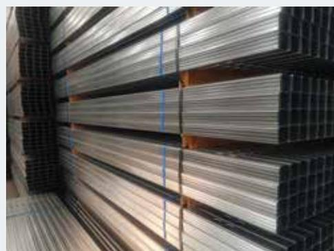
Fibran S.p.A. produce oltre ai profili nello spessore standard di 0,6 mm anche profili in spessore 0,8 e 1,0 mm, in grado di soddisfare tutte le esigenze statiche e sismiche. Su richiesta sono disponibili anche profili in Aluzinc.
